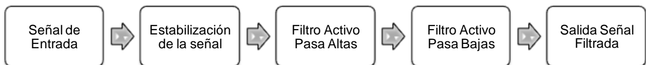
Figura 12 Diagrama a bloques de la etapa de filtrado
