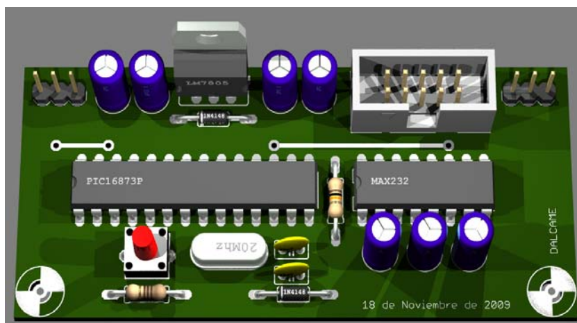
Board del circuito de de control de Electromiografía y Electroterapia
