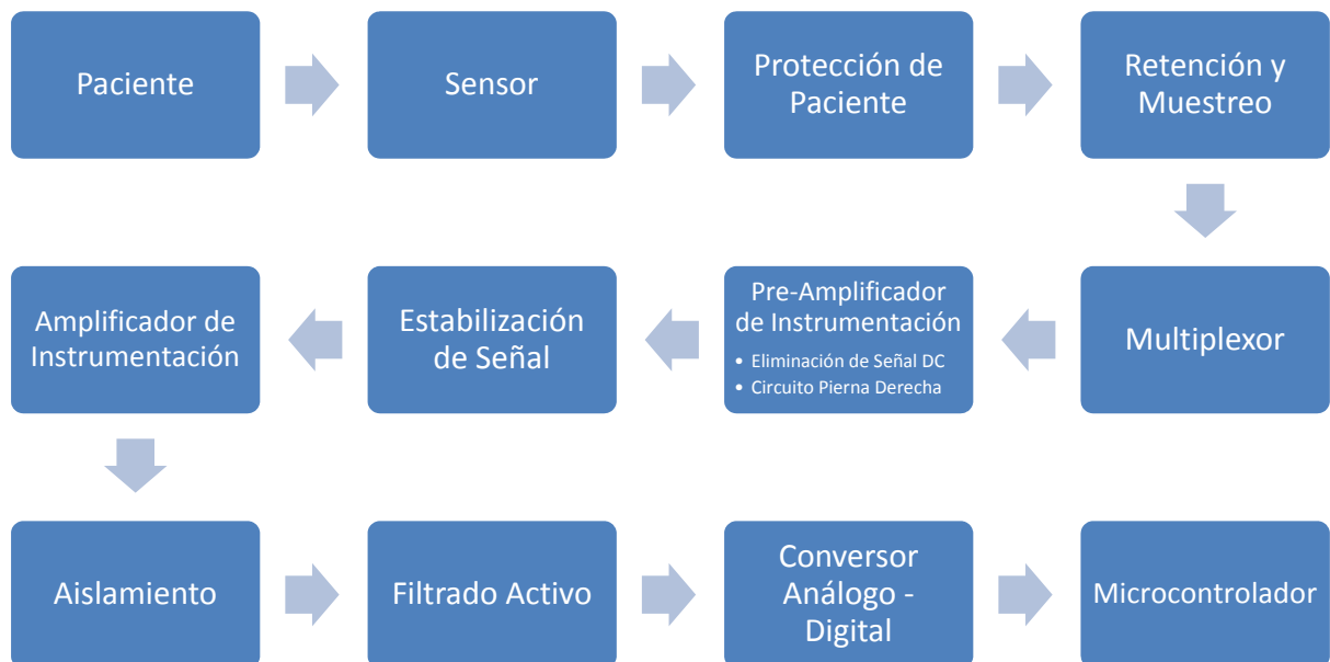
Figura No. 8 Diagrama a bloques de la Medición de Electrocardiografía
