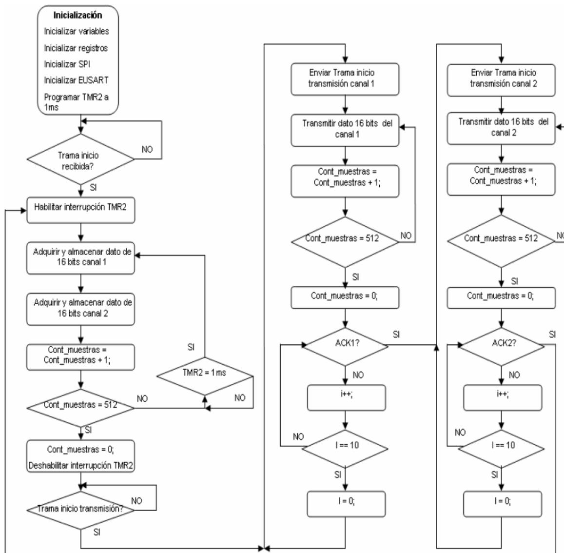
Tras la inicialización del microcontrolador, el programa deberá esperar una trama de inicio por parte del PC que le indique en Encendido o Apagado del circuito para comenzar a obtener los datos del paciente. Para ello se deberá habilitar la recepción de datos a través del módulo USART.
