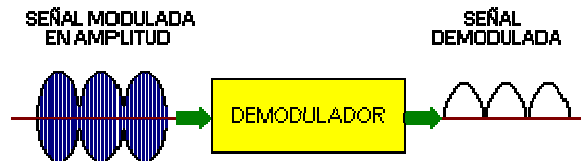
Figura No. 20 Señal Demodulada
