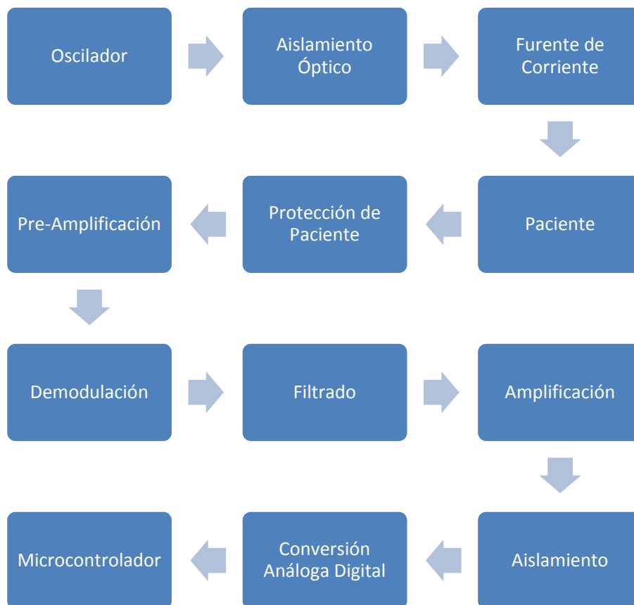
Figura No. 7 Diagrama a bloques de la medición de la Frecuencia Respiratoria
