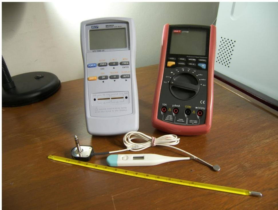
En formato Digital se anexa un video, en donde se observa la variación del Voltaje (equivalente a la temperatura en Grados Centígrados) en el Multímetro a medida que va aumentando la temperatura, al acercar un "cautín" al sensor y de igual manera disminuye al momento de alejar el "Cautín".
