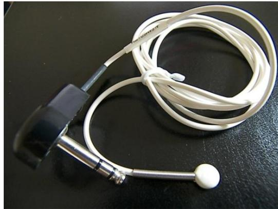
Figura No. 5 Sensor utilizado para medir la Temperatura Corporal
